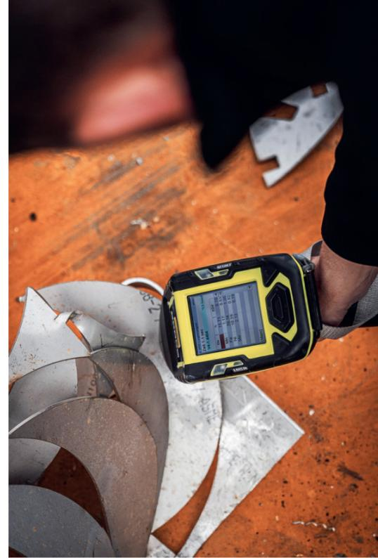
Mit Hilfe eines Röntgenfluoreszenz-Spektrometers werden die eingehenden Metalle auf ihre chemische Zusammensetzung überprüft.
