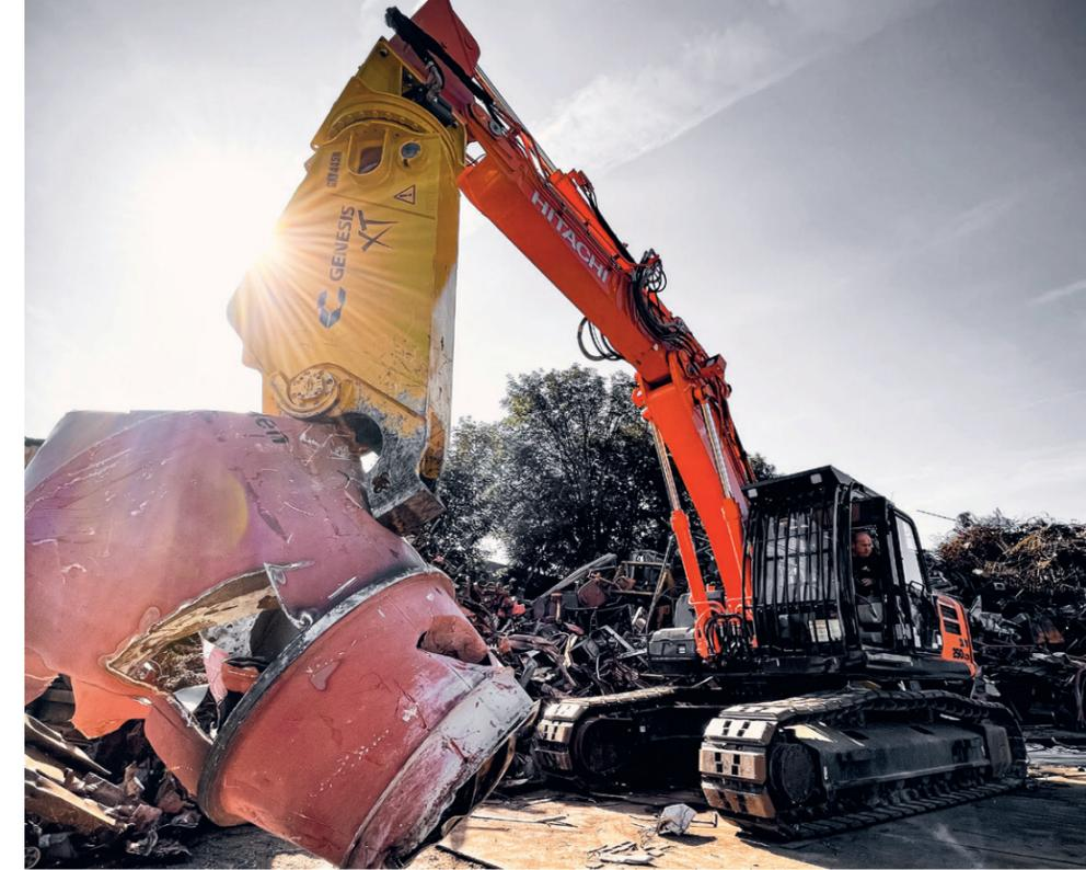
Zu groß oder zu schwer gibt es nicht – sperrige Teile werden mit einer Baggerschere mit 400 Tonnen Schneidkraft für das Stahlwerk zerkleinert.
